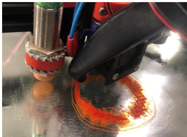
Εικόνα 4. 17 εκτύπωση κολιέ στον εκτυπωτή
