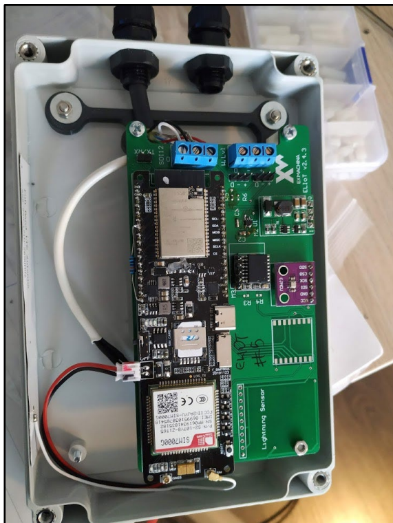
Εικόνα 42. Εσωτερικό ELIoT Node
