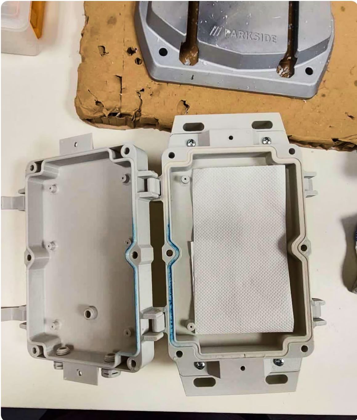
Εικ 133. Απεικόνιση περιβλήματος κόμβου ELIoT μετά απο επιτυχημένο έλεγχο αδιαβροχοποίησης
