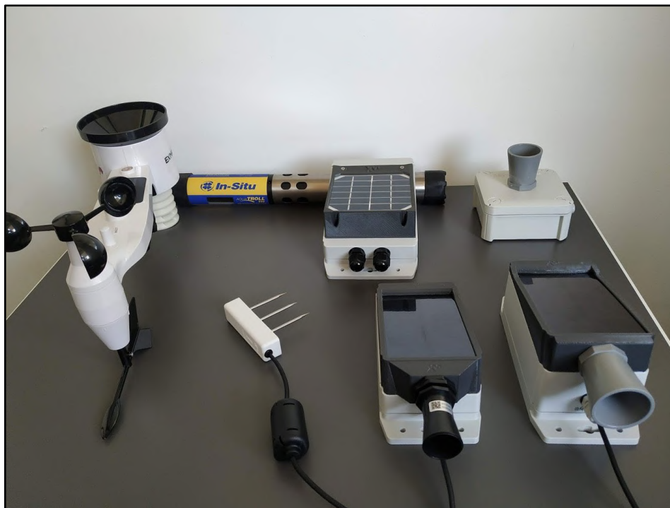
Εικόνα 52. Παραλλαγές ELIoT Node με ποικιλία αισθητήρων 3ης Γενιάς
