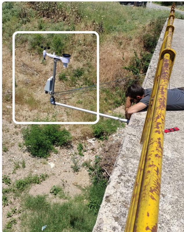
Εικόνα 64. Κόμβος ELIoT με ηχοβολιστικό στη γέφυρα της Σπάρτης (Αριστερά)
