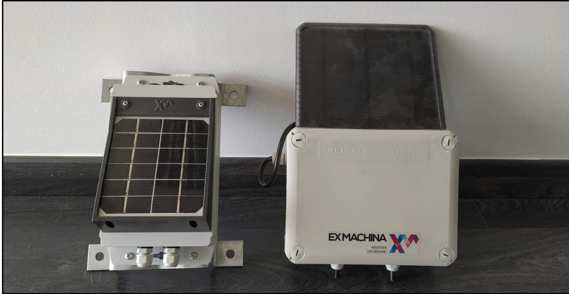
Εικόνα 40. Κουτί Hammond 1555HF17 (αριστερά) με το κουτί OBO T160 της προηγούμενης έκδοσης
