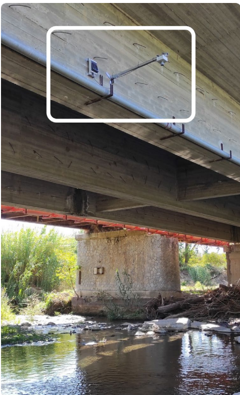
Εικόνα 64. Κόμβος ELIoT με ηχοβολιστικό στη γέφυρα της Σπάρτης (Αριστερά)
