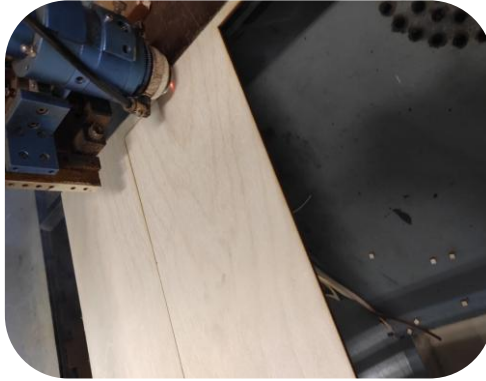
Εικόνα 61: Διαδικασία κοπής για το πίσω μέρος της κλειδοθήκης
