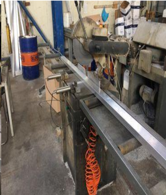
Εικόνα 3.2.5 Αρχικό μήκος πλαισίου και πριόνι κοπής
