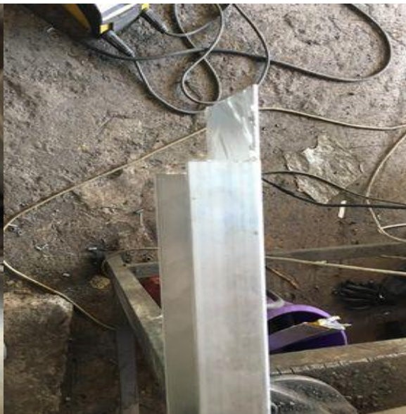
Εικόνα 3.2.13 Πλαίσιο βάσης στήριξης μετά την κοπή
