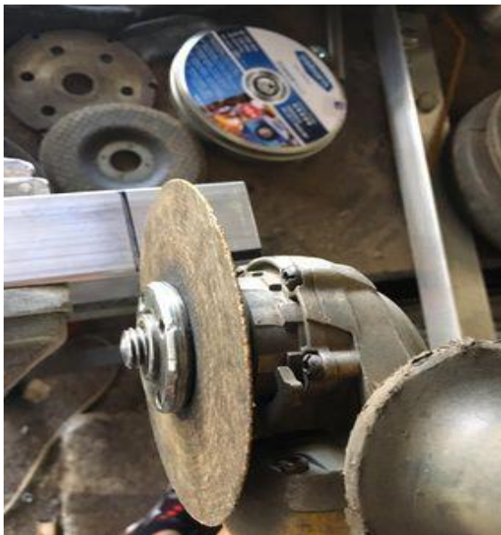
Εικόνα 3.2.12 Κοπή πλαισίου με τροχό
