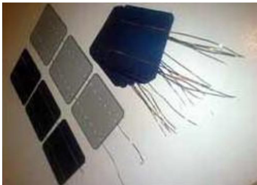
Εικόνα 4.4.2 Οι κυψέλες που θα χρησιμοποιηθούν για το πάνελ της κατασκευής
