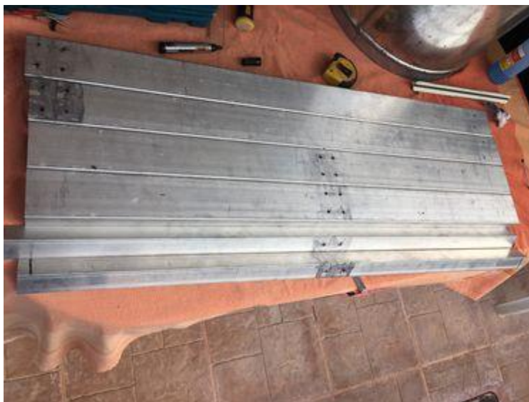
Εικόνα 3.2.19 Όλα τα πλαίσια για την βάση στήριξης σημειωμένα με τις οπές τους
