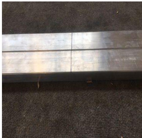
Εικόνα 3.2.2 Σημείωση διαστάσεων πλαισίων με μαρκαδόρο
