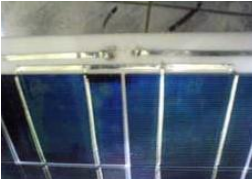
Εικόνα 4.4.7 Σύνδεση κυψελών πάνω μέρος του πάνελ
