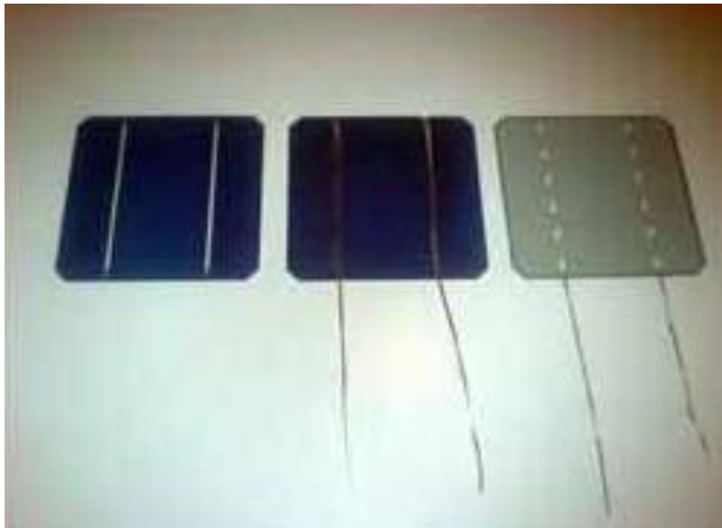
Εικόνα 4.4.1 Κυψέλες με καλωδιοταινία από την μπροστινή μεριά και την πίσω
