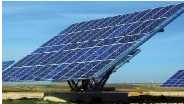
Εικόνα 1.5.4 Κινητό Σύστημα παρακολούθησης με κάθετο άξονα
