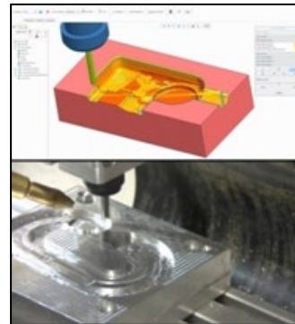
Εικόνα 9. Σχεδιασμός σε περιβάλλον CAD και λειτουργία εργαλειομηχανής.
