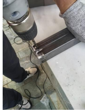
Εικόνα 68: Οι τρύπες για τις βέργες-οδηγούς
