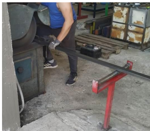
Εικόνα 50: Κοπή στις διαστάσεις που θέλουμε
