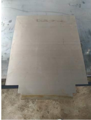
Εικόνα 34: Η λαμαρίνα στην τελική της μορφή πριν τη στράντζα
