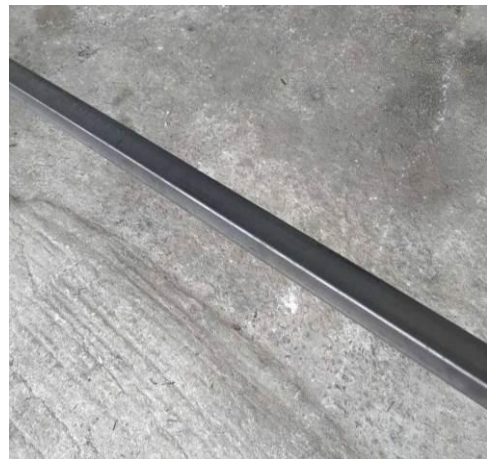
Εικόνα 49: Στραντζαριστός σωλήνας για τα κολωνάκια στήριξης
