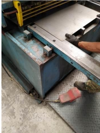
Εικόνα 30: Η λαμαρίνα κόβεται στις διαστάσεις που θέλουμε
