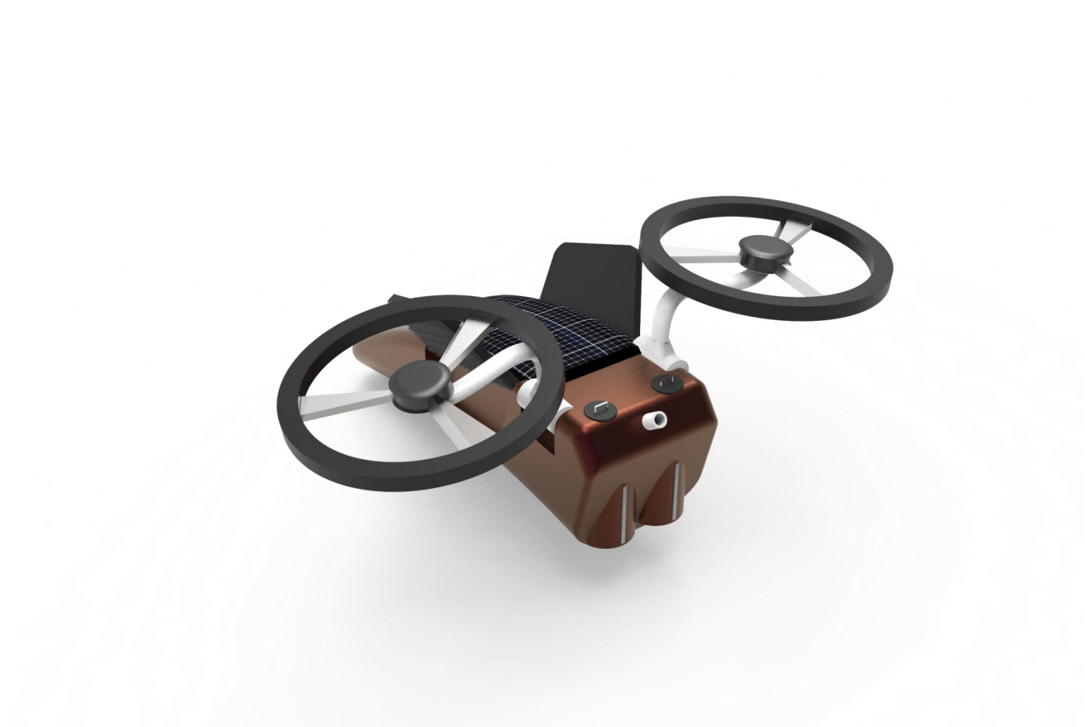
Εικόνα 12. Τελικό σχέδιο drone με ανοικτούς έλικες. Οπίσθια όψη. Διακρίνεται το σημείο φόρτισης με ηλεκτρική ενέργεια, καθώς και τα πόματα για το γέμισμα των δεξαμενών.
