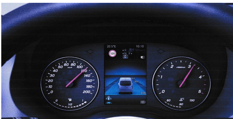
Εικόνα 20. Σύστημα υποβοήθησης σημάτων κυκλοφορίας
