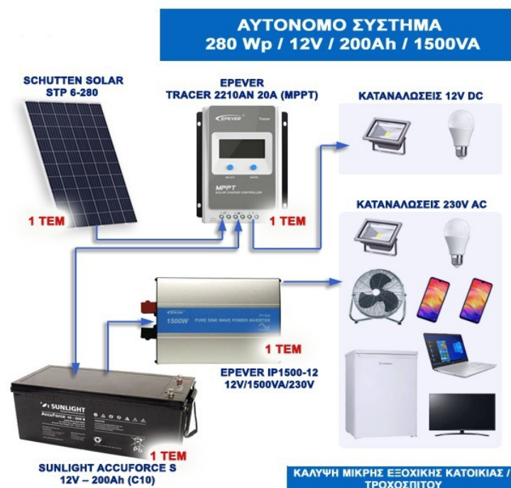
Εικόνα 40. Αυτόνομο φωτοβολταϊκό σύστημα
