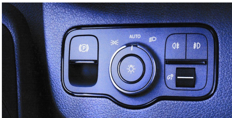
Εικόνα 22. Ηλεκτρικό φρένο στάθμευσης
