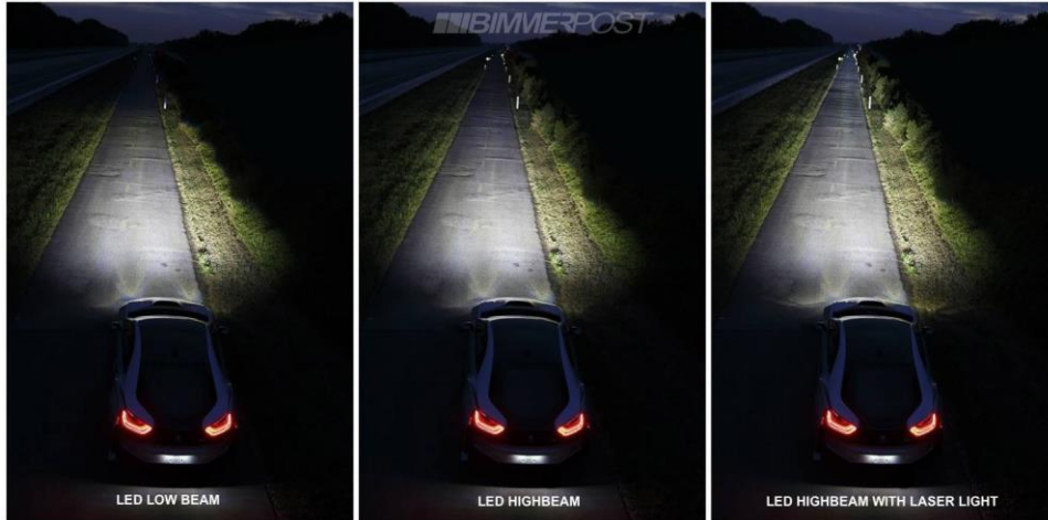
Εικόνα 63: Σύγκριση προβολών LED και προβολών Laser
