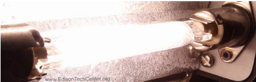
Εικόνα 27: Λαμπτήρας Αλογόνου κατά τη προθέρμανση (πάνω) και τον πλήρη φωτισμό (κάτω)
