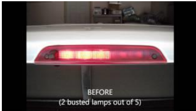
Εικόνα 70: CHMSL με καμμένους λαμπτήρες πυρακτώσεως
