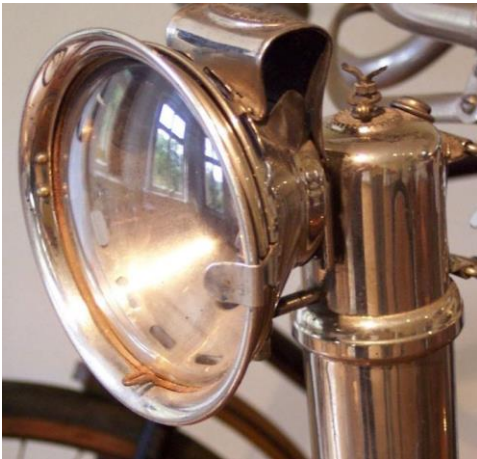
Εικόνα 55: Φανάρι καρβιδίου/ακετυλενίου προσαρμοσμένο σε ποδήλατο (Wikimedia Commons)
