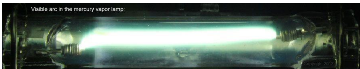
Εικόνα 20: Λάμπτα ατμών υδραργύρου όπου φαίνεται το φωτιζόμενο τόξο
