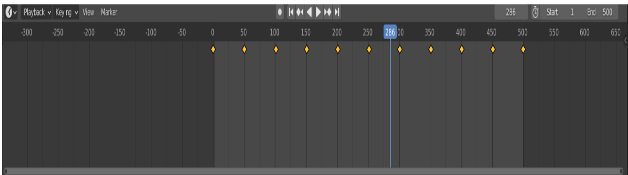
Εικ. 23: Timeline Editor με τα Keyframes (διαμάντια), Playhead (μπλε ορθογώνιο), Scrollbar (κατα μήκος της κάτω περιοχής), εργαλεία αναπαραγωγής στην μέση πάνω και καρέ εκίνησης και τέλους πάνω δεξιά
