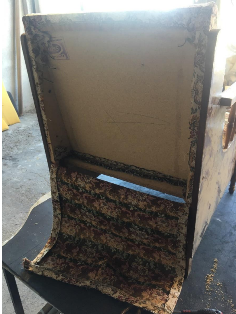
Εικόνα 8. Αφαίρεση του υφάσματος της πλάτης.
