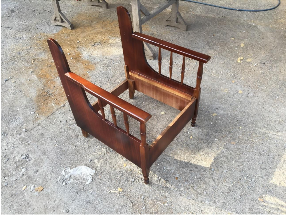
Εικόνα 17. Πρώτο χέρι βαφής.
