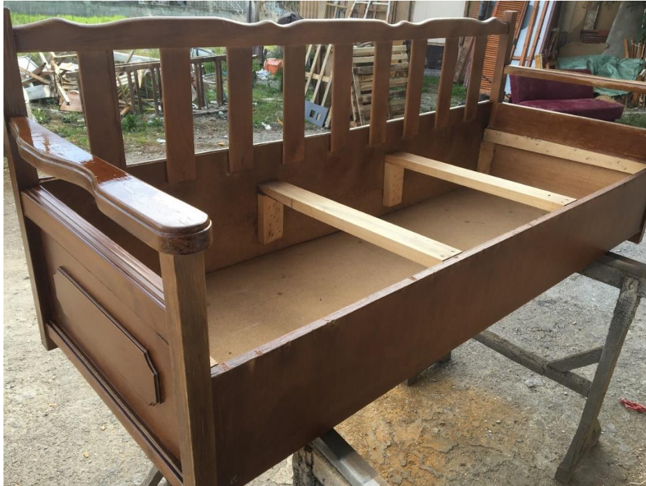
Εικόνα 22. Πρώτο χέρι βαφής
