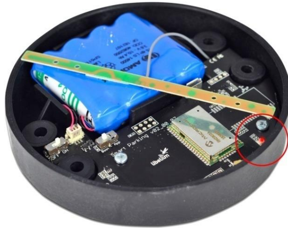
Εικόνα 61: Η κόκκινη λυχνία LED αναβοσβήνει μία φορά για να υποδείξει την κατάσταση ετοιμότητας προς εγκατάσταση
