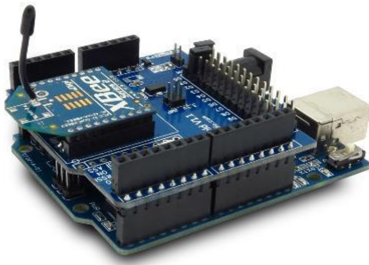
Εικόνα 36: Arduino με πομποδέκτη δεδομένων
