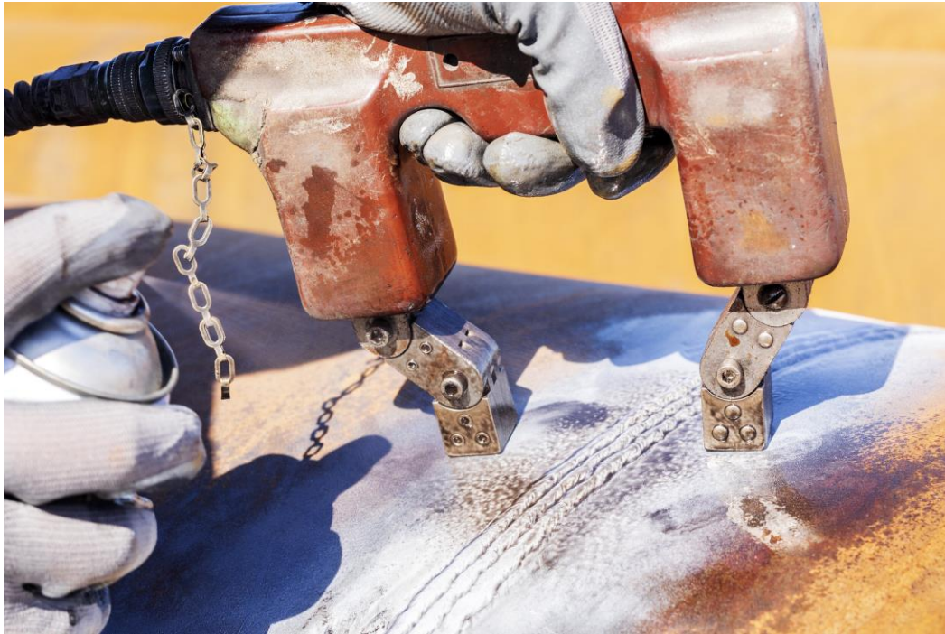
Εικόνα 1.15 Έλεγχος περιμέτρου σωλήνα με τη χρήση ηλεκτρομαγνήτη και μαγνητικών ρινισμάτων
