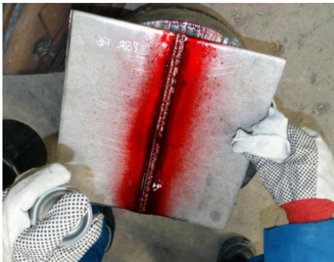
Εικόνα 1.14 Εφαρμογή διεισδυτικών υγρών σε συγκόλληση.
