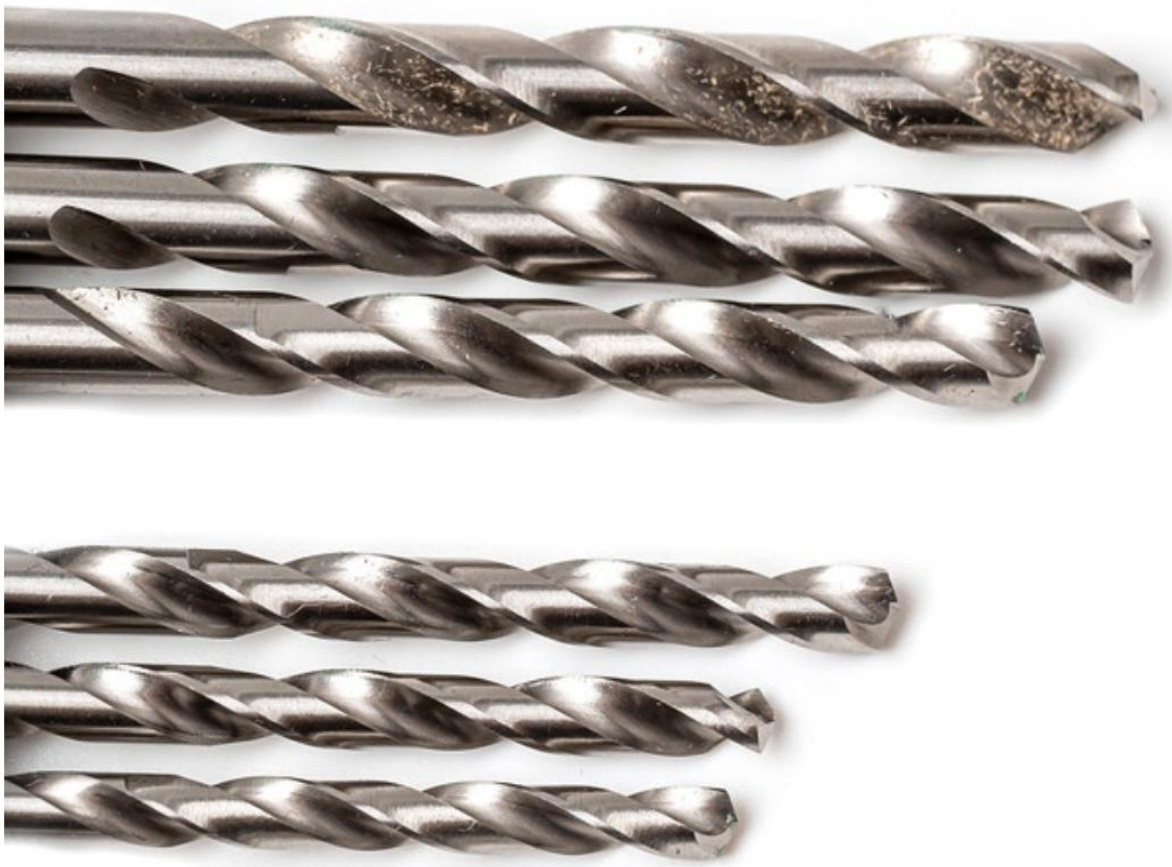
Εικόνα 25 Τα τρυπάνια διατίθενται σε πολλά τυποποιημένα μεγέθη
