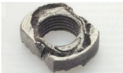
Εικόνα 18: Διάβρωση ρωγμής σε παξιμάδι από ανοξείδωτο χάλυβα
