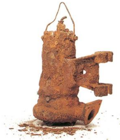
Εικόνα 16: Γενική διάβρωση σε αντλία από χυτοσίδηρο
