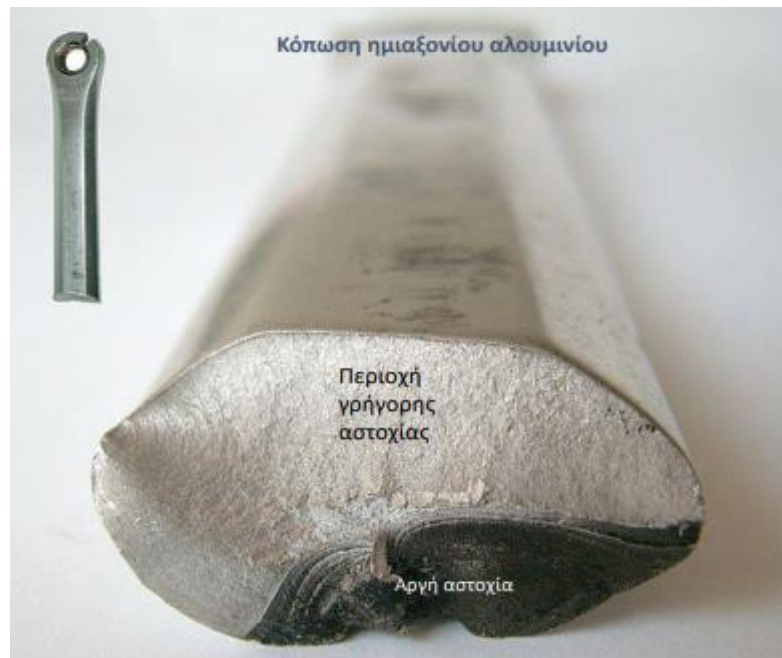
Εικόνα 9: Κόπωση ημιαξονίου αλουμινίου
