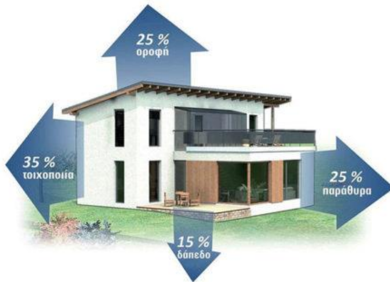
Εικόνα 5.43: Ποσοστό θερμικών απωλειών σε μη μονωμένη κατοικία (Πηγή : https://bit.ly/41EPmCJ )
