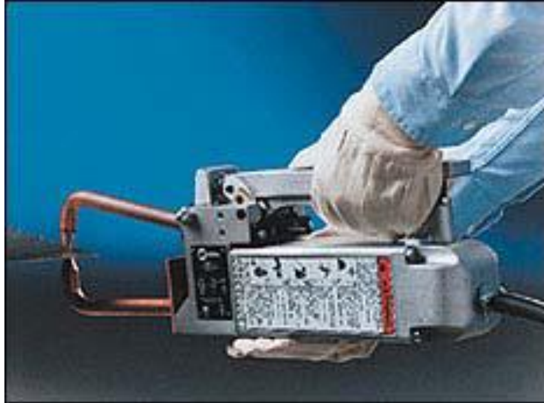
Εικόνα 22: Διάταξη φορητής μηχανής συγκόλλησης με αντίσταση.
