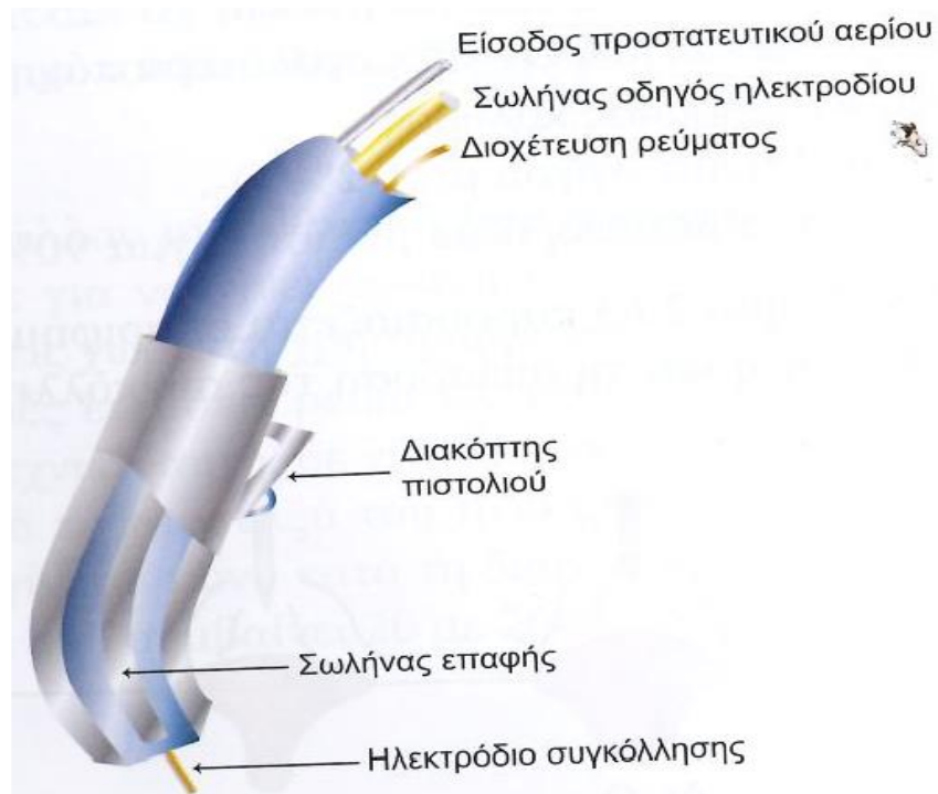
Εικόνα 26: Τυπικό αερόψυκτο πιστόλι συγκόλλησης GMAW
