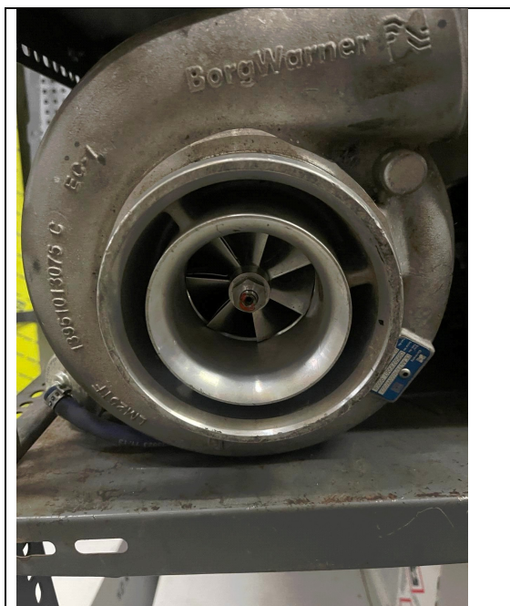
Εικόνα 3.41 : Μεταχειρισμένος υπερπληρωτής της εταιρείας Borg Warner που τοποθετήθηκε, πηγή : ZK Truck Parts
