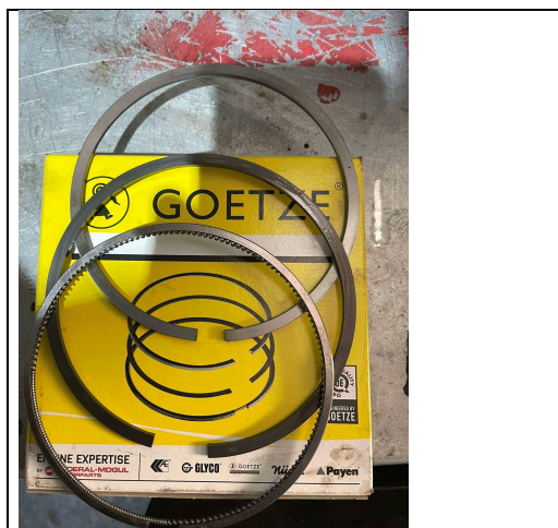
Εικόνα 3.16 : Στιγμιότυπο ελατηρίων GOETZE κατά την τοποθέτηση, πηγή : ZK Truck Parts
