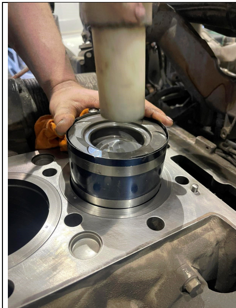
Εικόνα 3.21 : Στιγμιότυπο κατά την τοποθέτηση εμβόλων – διωστήρων, πηγή : ZK Truck Parts
