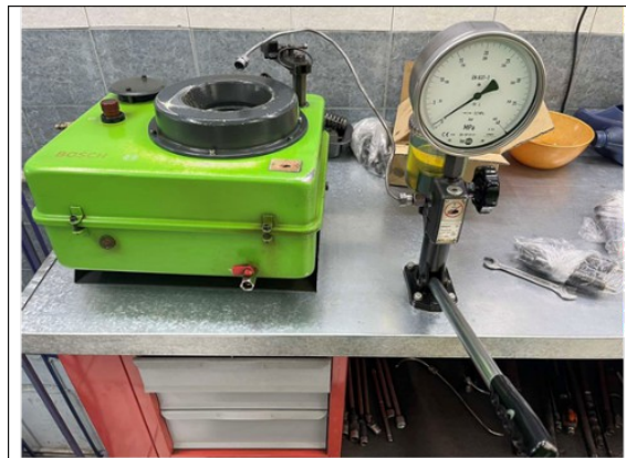
Εικόνα 3.39 : Μηχανή EPS 100 BUS IX της εταιρείας Bosch για έλεγχο μπέκ, πηγή : TURBO diesel
