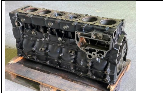
Εικόνα 2.2 : Κορμός μηχανής MAN TGS D 2876 LF01 εξακύλινδρος κινητήρας σε σειρά, πηγή : Foreas Trucks
