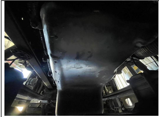
Εικόνα 3.44 : Στιγμιότυπο τοποθετημένου δοχείο λαδιού (κάρτερ) του κινητήρα μας, πηγή : ZK Truck Parts
