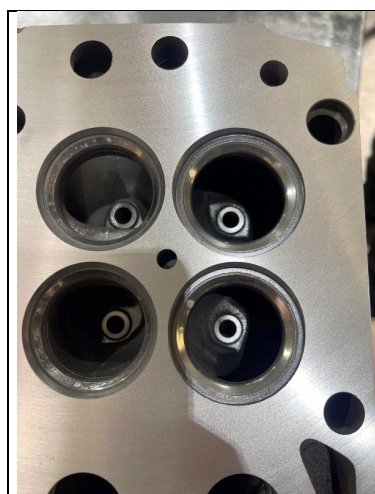
Εικόνα 3.30 : Στιγμιότυπο στο τέλος του ρεκτιφιέ επιφανείας, πηγή : Ρεκτιφιέ Express
