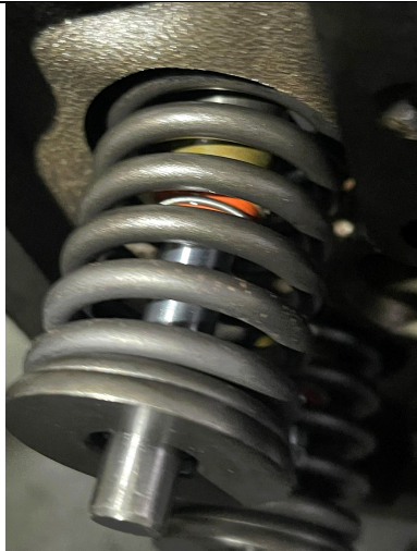
Εικόνα 3.32: Στιγμιότυπο κατά την συναρμολόγηση ελατηρίων – βαλβίδων, πηγή : ZK Truck Parts
