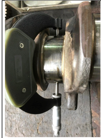
Εικόνα 3.12 : Στιγμιότυπο από τον έλεγχο του στροφαλοφόρου άξονα, πηγή : ZK truck parts
