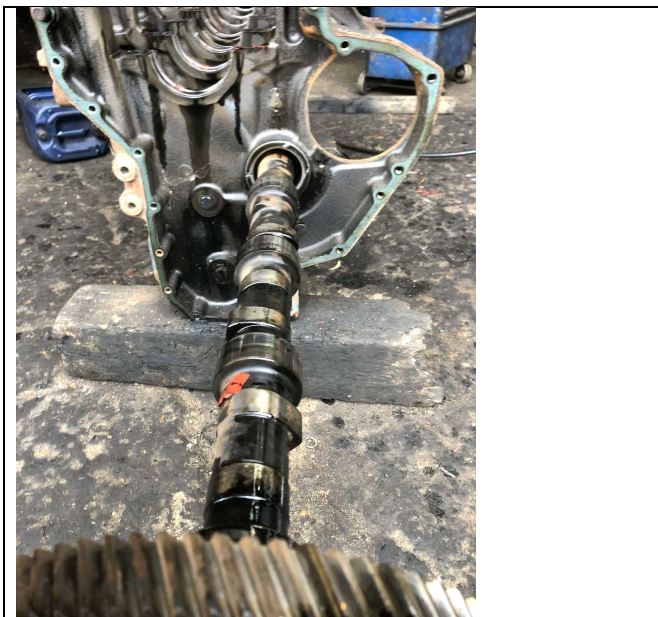
Εικόνα 3.14 : Σημείο τοποθέτησης εκκεντροφόρου άξονα, πηγή : ZK Truck Parts
