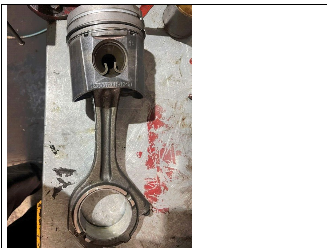
Εικόνα 3.17 : Στιγμιότυπο ολοκληρωμένης σύνδεσης διωστήρα – εμβόλου (με εμφανή σημεία : πύρος και ασφάλεια), πηγή : ZK Truck Parts
