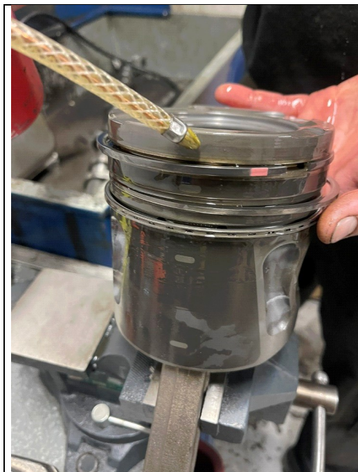
Εικόνα 3.15 : Στιγμιότυπο κατά την τοποθέτηση και ρύθμιση των ελατηρίων των εμβόλων, πηγή : ZK Truck parts
