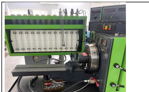
Εικόνα 3.40 : Μηχανή EPS 711 της εταιρείας Bosch με πρόσθετο εξοπλισμό για έλεγχο EDC, πηγή : TURBO diesel
