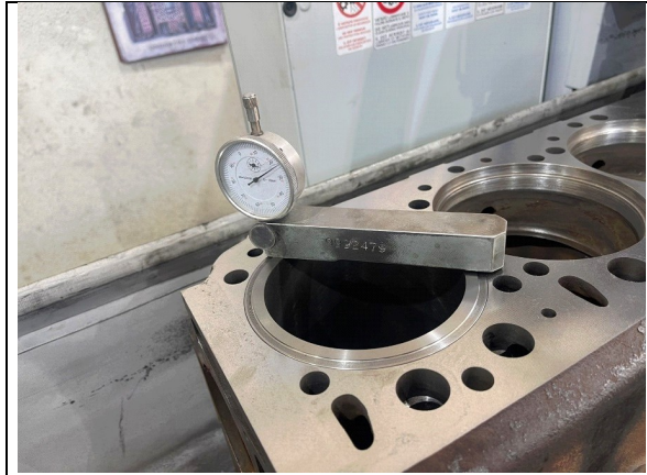
Εικόνα 3.8 : Στιγμιότυπο τελικού αποτελέσματος της επεξεργασίας επιφάνειας με δοκιμή ανύψωσης χιτωνίου, πηγή : Ρεκτιφιέ Express
