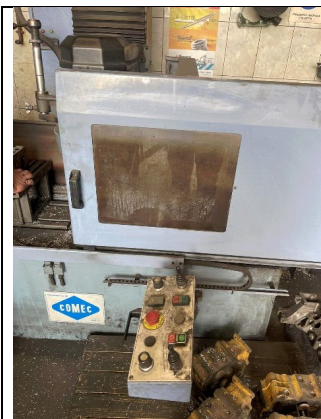
Εικόνα 3.28 : Απεικόνιση της πλάνης RP1300 της εταιρείας COMEC, πηγή : Ρεκτιφιέ Express
