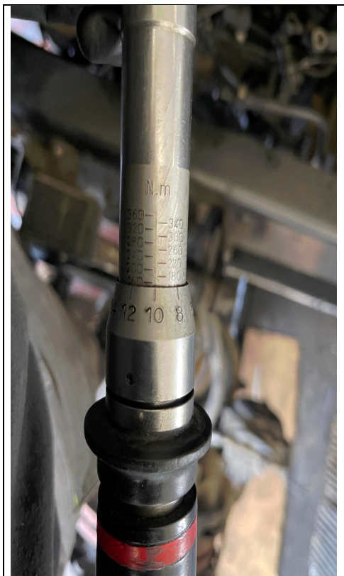
Εικόνα 3.38 : Στιγμιότυπο ρύθμισης ροπόκλειδου, πηγή : ZK Truck Parts
