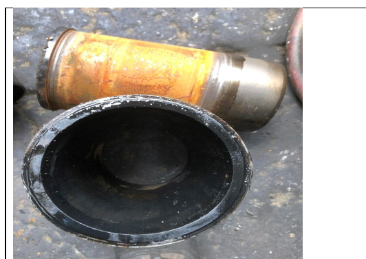
Εικόνα 3.4 : Στιγμιότυπο χιτωνίων κατά την αποσυναρμολόγηση του κινητήρα, πηγή : ZK truck parts
