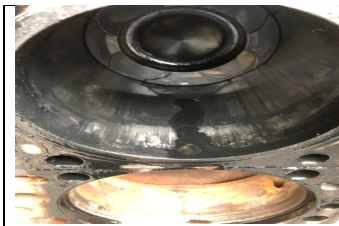
Εικόνα 3.6 : Στιγμιότυπο φθαρμένου κυλίνδρου κατά την αποσυναρμολόγηση, πηγή : ZK truck parts
