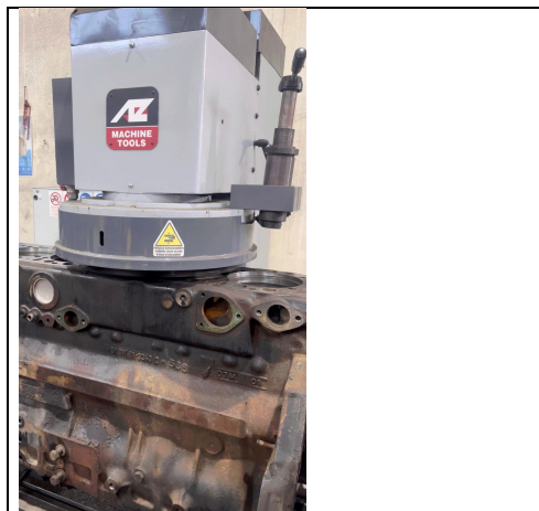
Εικόνα 3.9 : Στιγμιότυπο κατά τη λειτουργία της πλάνης SP1300Y της AZ MACHINE TOOLS, πηγή : Ρεκτιφιέ Express
