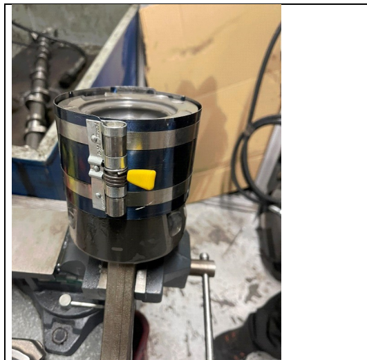
Εικόνα 3.19 : Στιγμιότυπο κατά την προετοιμασία πριν την τοποθέτηση, ειδικός σφικτήρας ελατηρίων, πηγή : ZK Truck Parts
