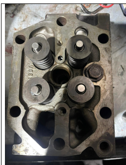
Εικόνα 3.34 : Τελικό αποτέλεσμα συναρμολόγησης κατακτιού κυλινδροκεφαλής, πηγή : ZK Truck Parts
