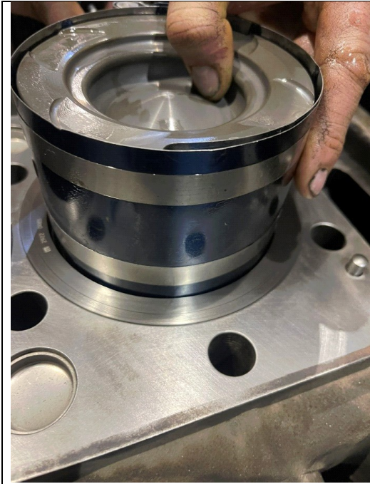
Εικόνα 3.20 : Στιγμιότυπο κατά την τοποθέτηση εμβόλων – διωστήρων, πηγή : ZK Truck Parts
