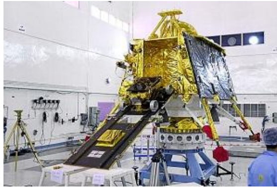
Εικόνα 30: Το όχημα προσεδάφισης Chandrayaan 2 φορτώνοντας το rover Pragyan
