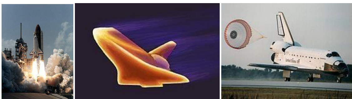
Εικόνα 18: Το διαστημικό λεωφορείο Atlantis εκτοξεύεται ξεκινώντας την αποστολή STS-71 (αριστερά), στις εξωτερικές επιφάνειες του σκάφους αναπτύσσονται θερμοκρασίες έως και 1.500°C κατά τη διάρκεια της επανεισόδου στην ατμόσφαιρα της Γης (μέσον), το Endeavour στη φάση της προσγείωσης (δεξιά)
