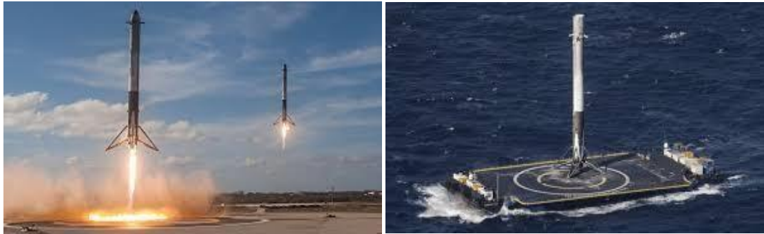
Εικόνα 27: Προσγείωση των προωθητών (booster) του Falcon 9 Heavy το 2018 (αριστερά), προσγείωση του προωθητή Falcon 9 στην τηλεκατευθυνόμενη πλατφόρμα “Of course I still love you” το 2016 (δεξιά)
