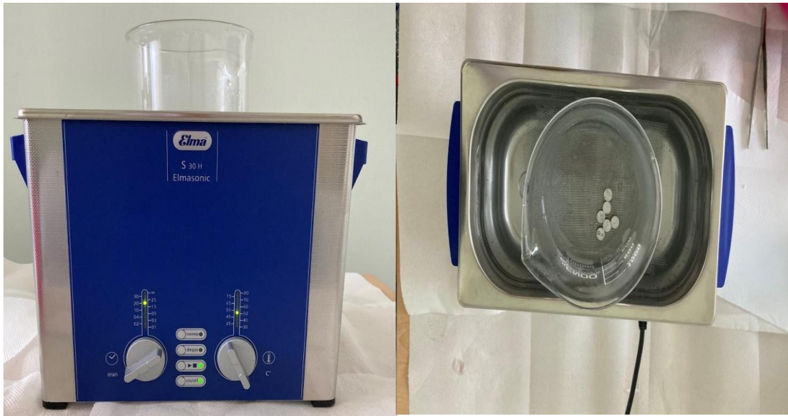
Εικόνα 18. Καθαρισμός δοκιμών με υπέρηχους.
