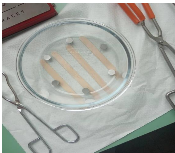
Εικόνα 22. Τοποθέτηση δοκιμών σε πυρίμαχο σκεύος για σκλήρυνση
