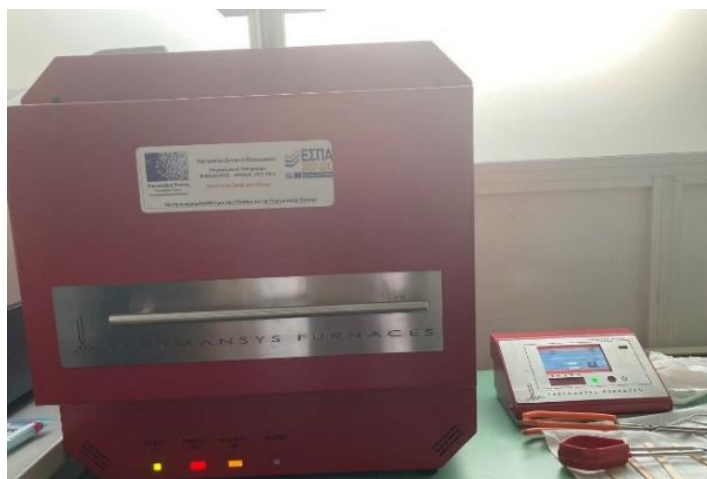
Εικόνα 23. Ο φούρνος σε χρήση, με rate 5°C/min
