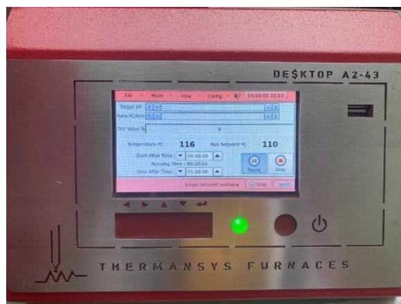
Εικόνα 23. Ο φούρνος σε χρήση, με rate 5°C/min
