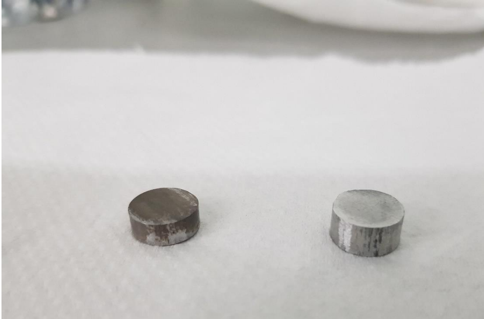
Εικόνα 29. Δοκίμια μετά από τη βύθισή τους σε NaCl, αριστερά είναι το μη επικαλυμμένο, δεξιά με επικάλυψη
