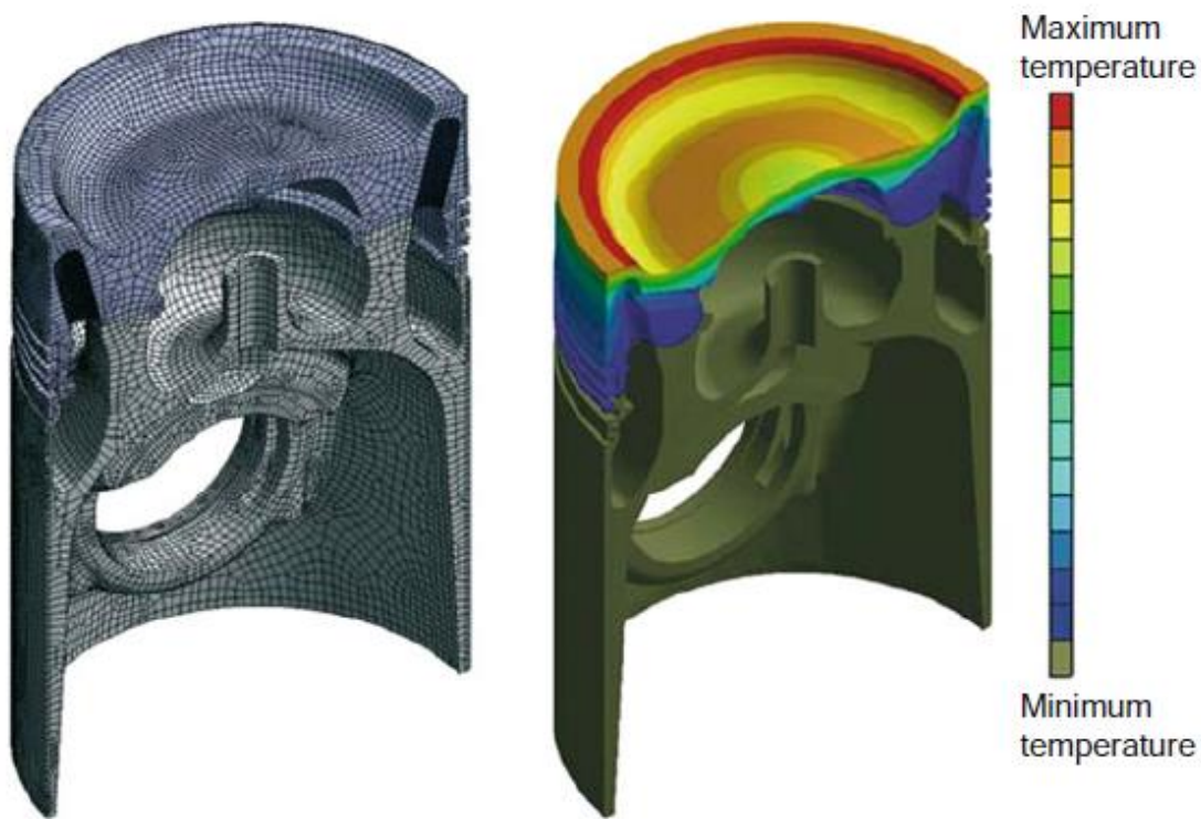
Σχήμα 1.4: Μοντέλο FEM ενός πιστονιού από σύνθετο ασάλι με μαθηματικά προσδιορισμένη κατανομή θερμοκρασίας
