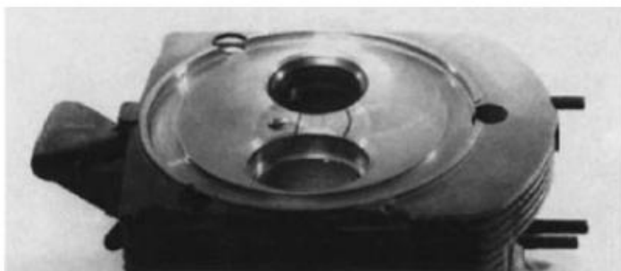
Σχήμα 2.17: Χυτές ατσάλινες πλάκες στις γέφυρες των βαλβίδων για να αποτραπούν ρωγμές της γέφυρας των βαλβίδων στην κυλινδροκεφαλή ενός αερόψυκτου κινητήρα ντίζελ (Deutz AG FL 513)
