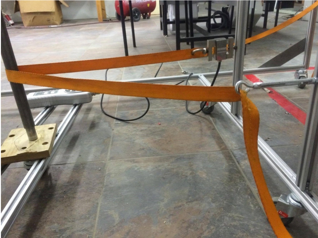
Σχήμα 3.11 Πειραματικός υπολογισμός δύναμης του άξονα
