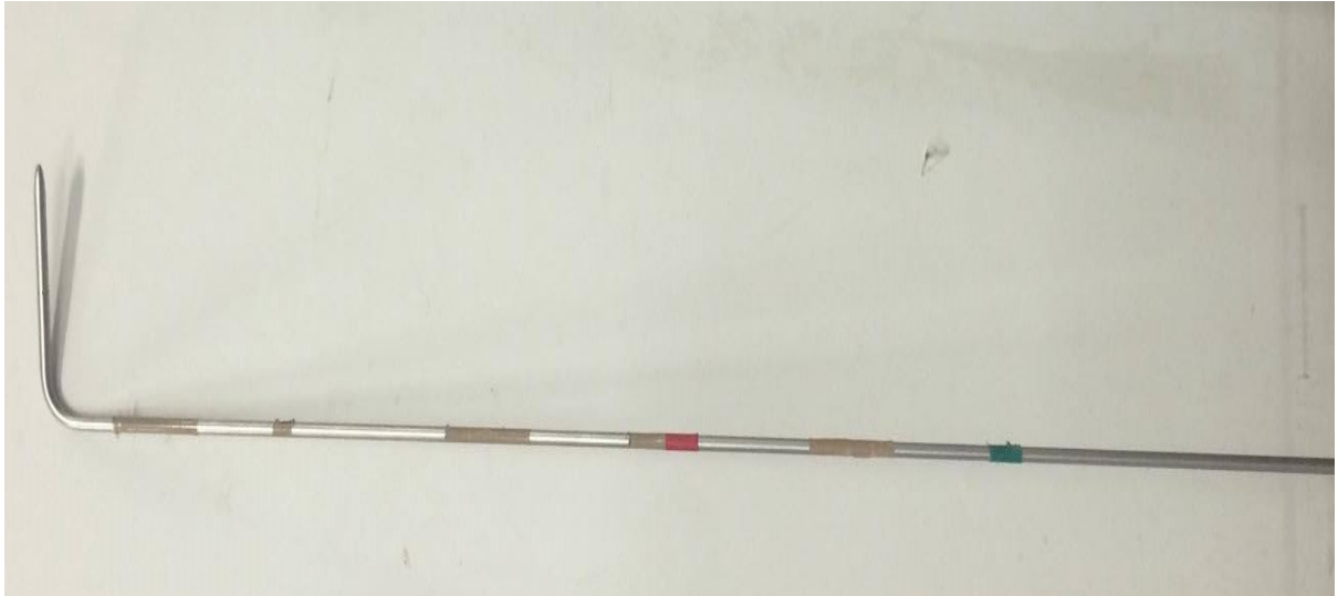
Σχήμα 3.15 Βαθμονόμηση Σωλήνα Pitot
