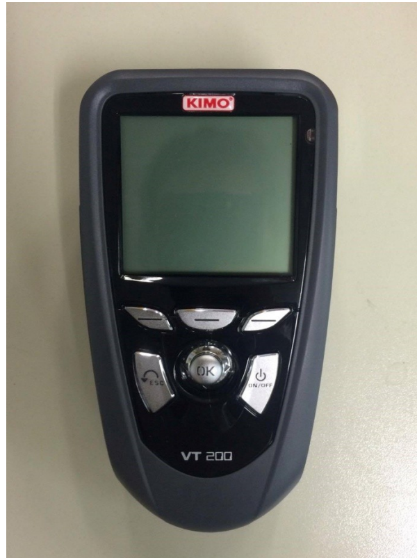
Εικόνα 3.6 Ηλεκτρονικό μανόμετρο VT 200
