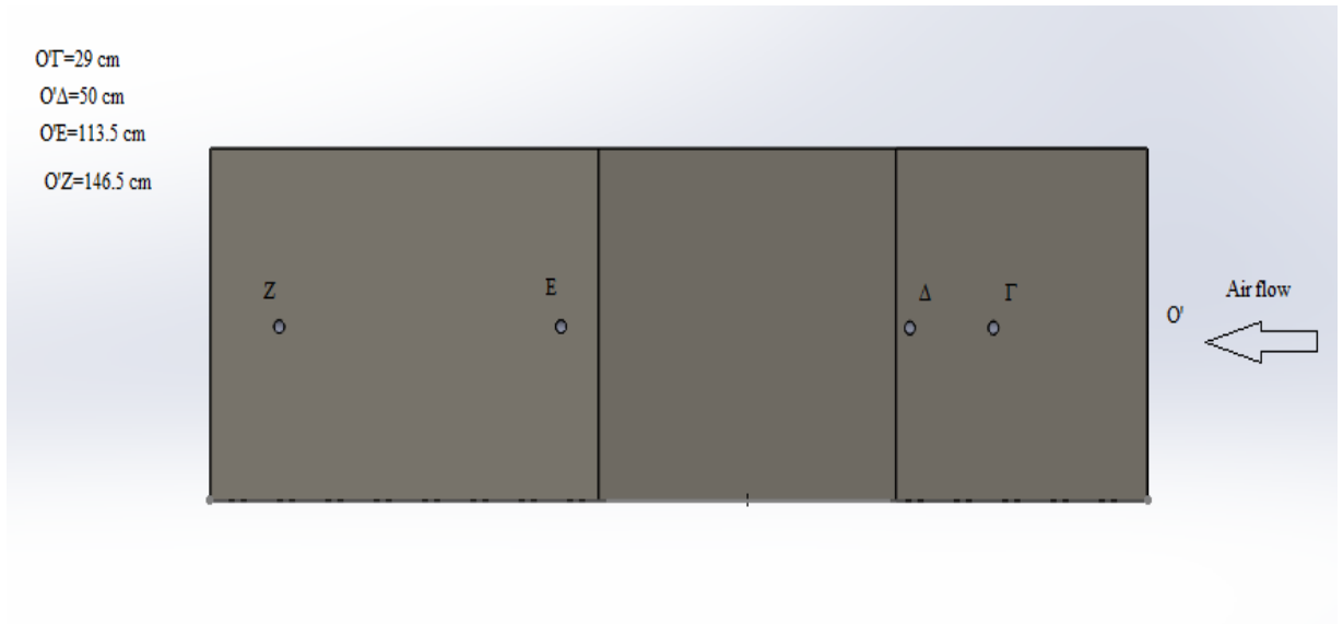
Σχήμα 3.14 Οπές στο πλευρικό μέρος του κελύφους
