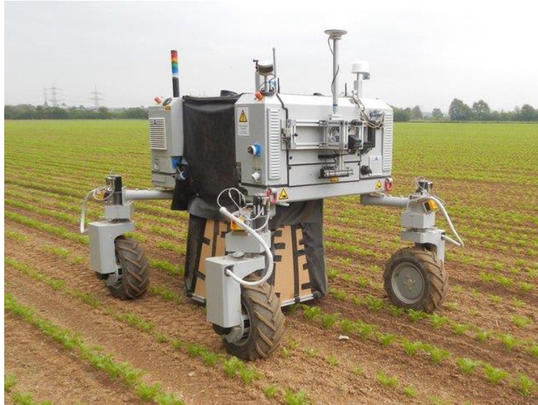
Εικόνα 11 – Μη Επανδρωμένο Όχημα για την εντοπισμό και καταπολέμηση των ζιζανίων
