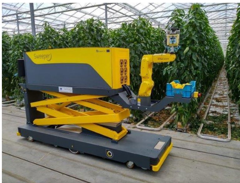
Εικόνα 10 – Μη Επανδρωμένο Όχημα για την συγκομιδή πιπεριών
