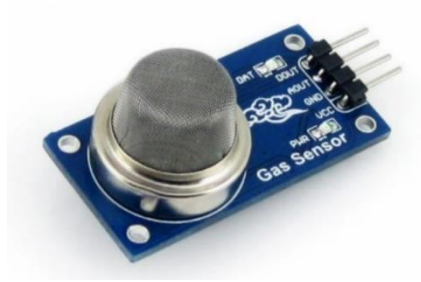
Εικόνα 28 - Αισθητήρας MQ135 για την μέτρηση του CO2
