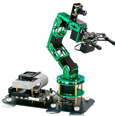
Figure 4: Κιτ ρομποτικού βραχίονα ρομπότ Raspberry Pi AI Hand Building με κάμερα 6-DOF [19].
