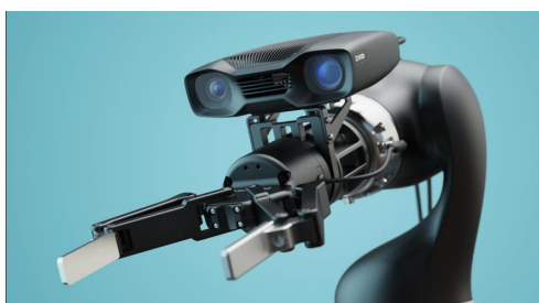
Figure 3: Ρομποτική κάμερα Zivid 2 τρισδιάστατης όρασης τοποθετημένη σε ρομπότ [17].
