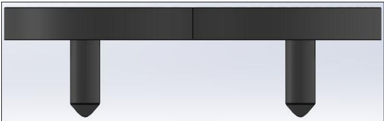
Εικόνα 4-23: Τελικό σχέδιο μεταλλικού προθέματος κνήμης
