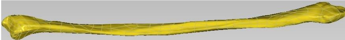
Εικόνα 3-16: Αρχικό μοντέλο περόνης σε μορφή CAD, με επιφάνειες NURBS
