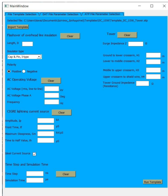
Σχήμα 5.8: Καρτέλα στην οποία εισάγονται τα δεδομένα για τα υπόλοιπα στοιχεία της γραμμής μεταφοράς ηλεκτρικής ενέργειας εκτός των αγωγών και των αγωγών προστασίας (για το αρχείο *.atp).
