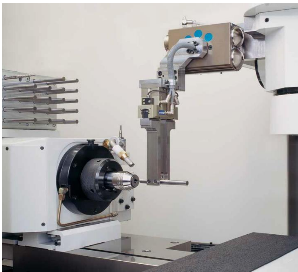
Εικόνα 29 : Φόρτωση του προς επεξεργασία μετάλλου
