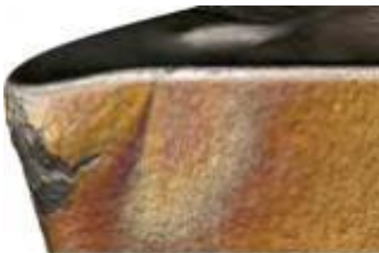
Εικόνα 3.15: Φθορά λόγω πλαστικής παραμόρφωσης στην κοπτική ακμή
