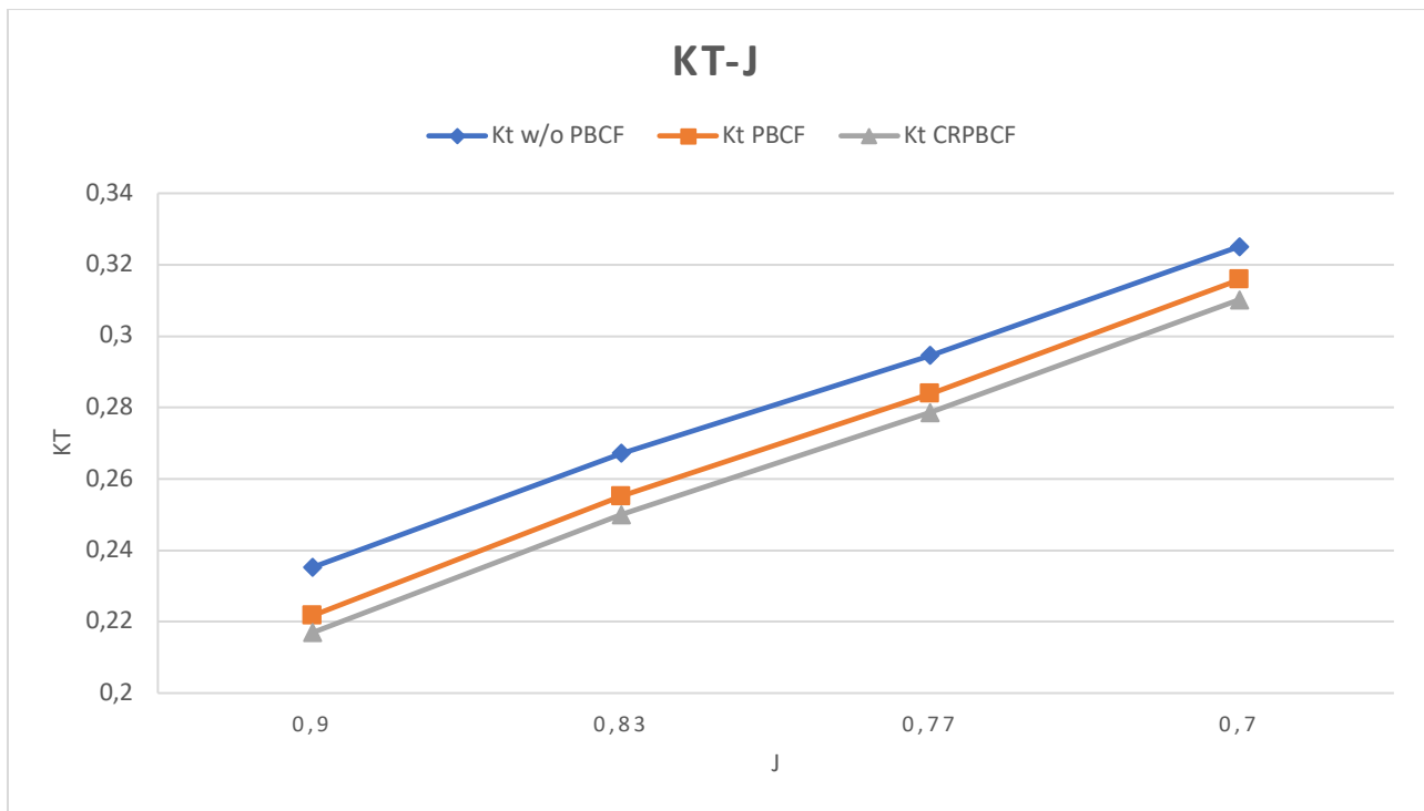
Διάγραμμα 4.5. Αποτελέσματα των συντελεστών ώσης της προπέλας χωρίς και με την προσθήκη βοηθητικών πτερυγίων.
