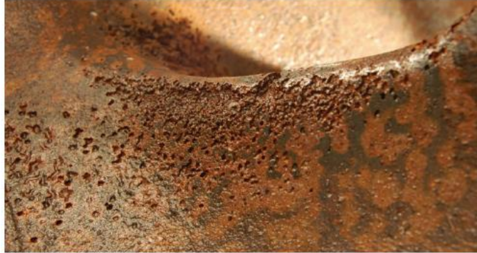
Εικόνα 1 Διάβρωση επιφάνειας πτερωτής λόγω σπηλαιώσης Πηγή: Thamsen, P.U., et al., (2008) Cavitation in Single-Vane Sewage Pumps. International Journal of Rotating Machinery
