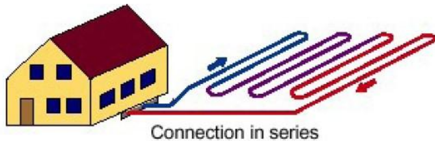
Σχήμα 2.25 Τοποθέτηση σωληνώσεων σε σειρά (Πηγή: http://www.earthrivergeo.com )
