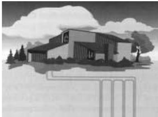
Σχήμα 2.13 Κατακόρυφος γεωναλλάκτης κλειστού κυκλώματος (Πηγή: http://www.tmltd.gr )
