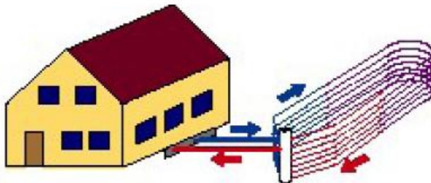
Σχήμα 2.28 Κύκλωμα στενής διαμέτρου αγωγού (Πηγή: http://www.earthrivergeo.com )
