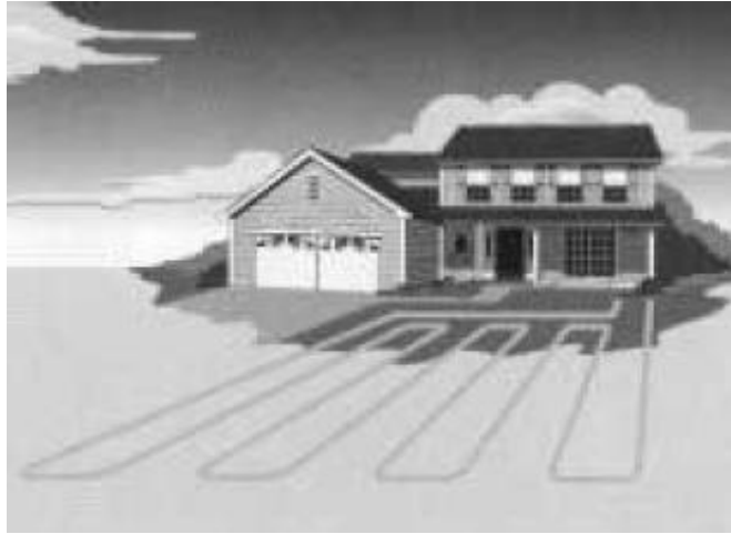
Σχήμα 2.12 Οριζόντιος γεωναλλάκτης κλειστού κυκλώματος (Πηγή: http://www.tmltd.gr )
