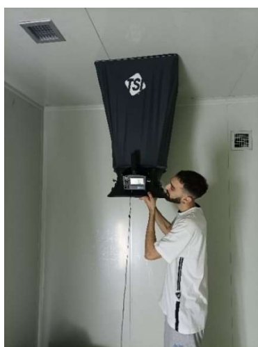
Εικόνα 6.1 και 6.2 Μέτρηση παροχής αέρα με το TSI Balometer
