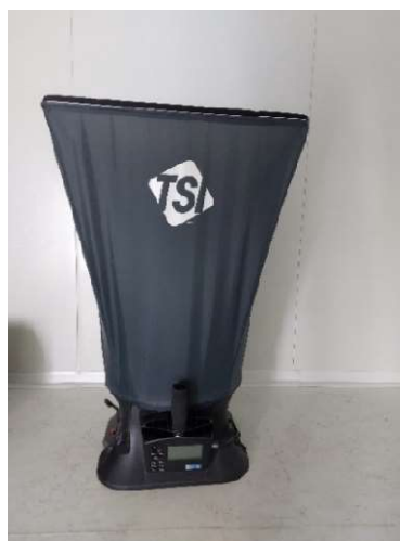
Εικόνα 6.1 και 6.2 Μέτρηση παροχής αέρα με το TSI Balometer
