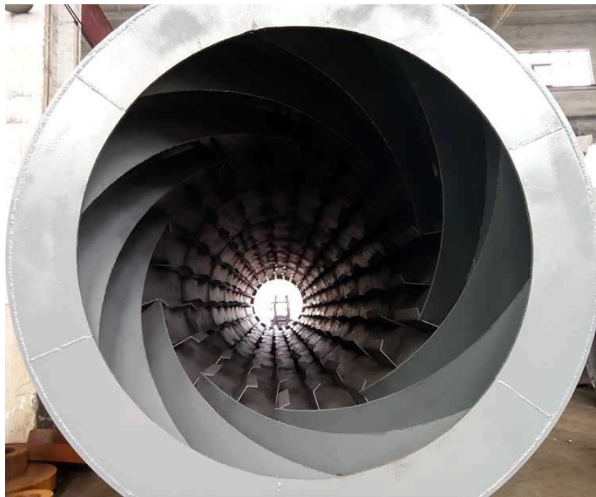
Εικόνα 3.2: Εσωτερική όψη τυμπάνου με μεταλλικά πτερύγια (cementplantsupplier)
