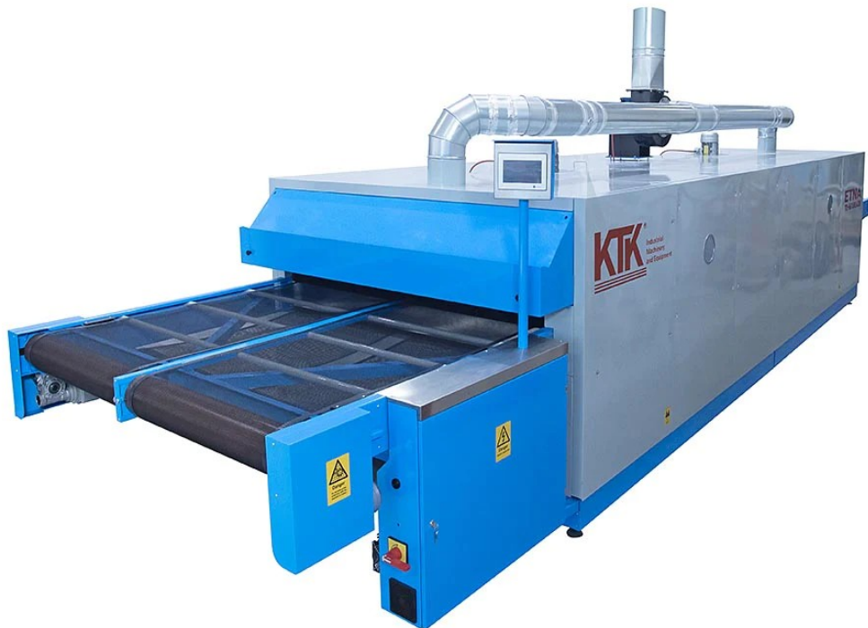
Εικόνα 3.4 :φωτογραφία ξηραντηρίου τούνελ
