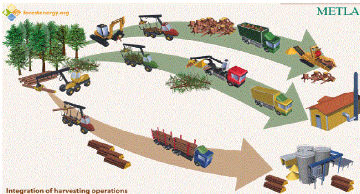
Εικόνα 12: Παράδειγμα μιας εφοδιαστικής αλυσίδας που συνδυάζει την ξυλεία κορμού (κύριο προϊόν) με τα δασικά υπολείμματα όπως ρίζες και κλαδιά 17
