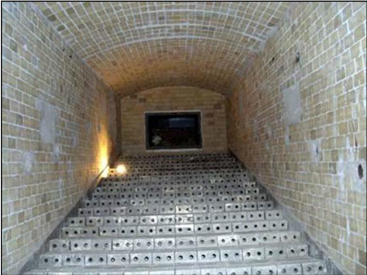
Εικόνα 23: Θάλαμος καύσης με κινούμενη εσχάρα 24
