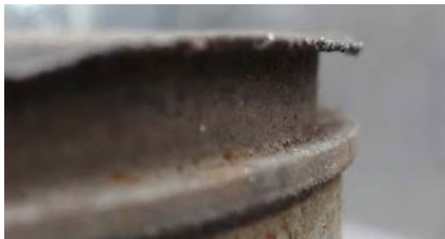
Εικόνα 38: Παράδειγμα αστοχίας - Κύρτωση προεξοχής [31]
