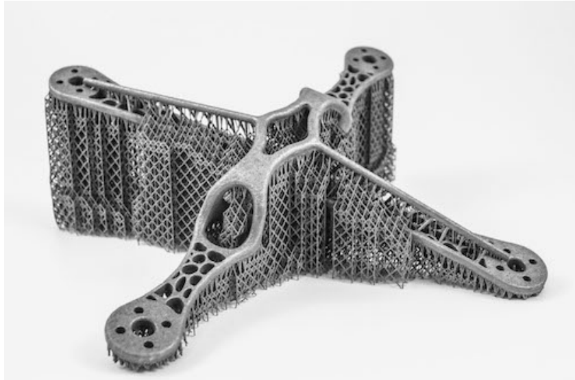
Εικόνα 29: Υποστηρικτικές δομές για την επίτευξη εκτόπισης της γεωμετρίας [30]
