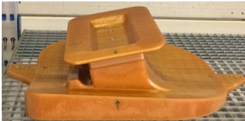
Εικόνα 46: Τελική μορφή καλουπιού μέσω τρισδιάστατης εκτύπωσης [43]
