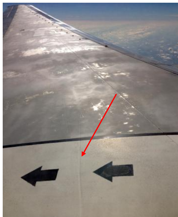
Σχήμα 4: Δισδιάστατη αναπαράσταση κρουστικού κύματος (αριστερά) ( quora.com ) Κρουστικό κύμα σε πτέρυγα επιβατικού αεροσκάφους (δεξιά) ( mdolab.engin.umich.edu )
