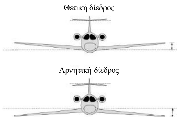
Σχήμα 80: Διεδρος γωνία (Leishman, 2022)
