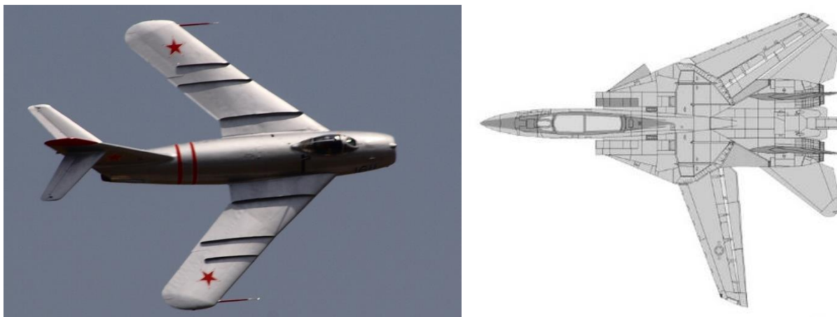
Σχήμα 5: Το Σοβιετικό MiG-17 με οπισθόκλιση 45 μοιρών (αριστερά) F-14 με πτέρυγες μεταβαλλόμενης οπισθόκλισης (δεξιά) (Wikipedia)
