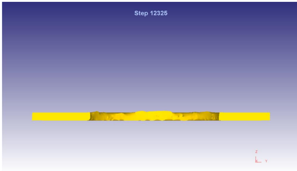
Εικόνα 7.14.: Η ποιότητα της σπής μετά τη διάτρηση με εργαλείο μικρού πτερυγίου.
