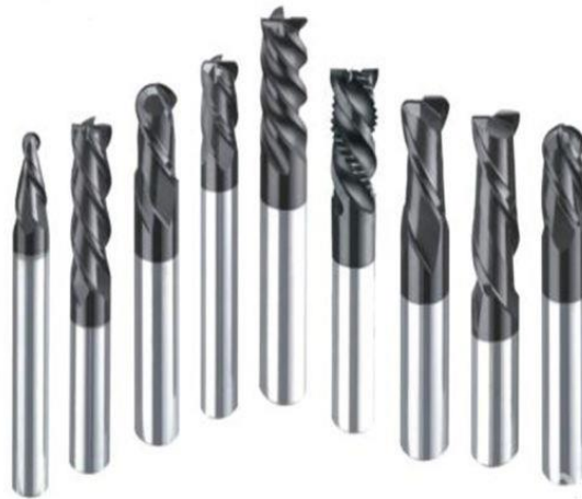
Εικόνα 3.12.: Κοπτικά εργαλεία από ανθρακούχο χάλυβα.
