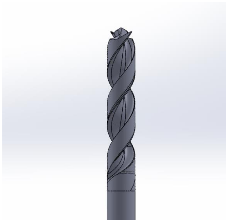
Εικόνα 5.24.:Ολοκληρωμένο το τρυπάνι με μήκος πτερυγίων 0,93mm.
