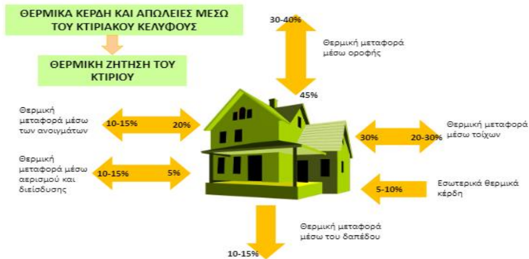
Εικόνα 1.3. Θερμικά κέρδη και απώλειες κελύφους του κτηρίου .
