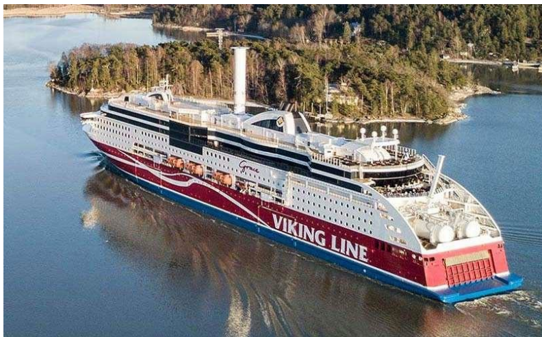
Εικόνα 26: M/S Viking Grace με τοποθετημένο ρότορα (Πηγή: https://www.vikingline.com/the-group/viking-line/vessels/ms-viking-grace/ ).
