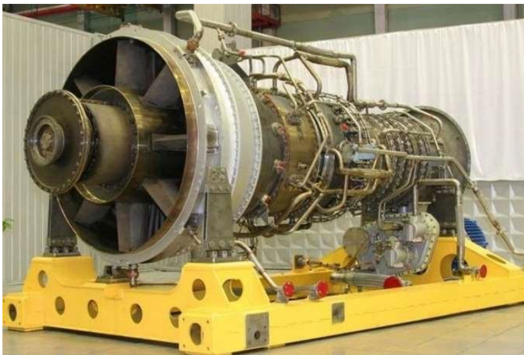
Εικόνα 7: Απεικόνιση προωστήριου αεριοστροβίλου πολεμικού πλοίου.
