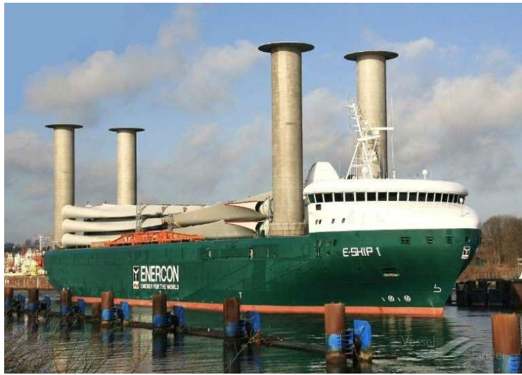
Εικόνα 25: Το πλοίο E-ship1 με τους τέσσερις (4) ρότορες (Πηγή: https://www.vesselfinder.com )
