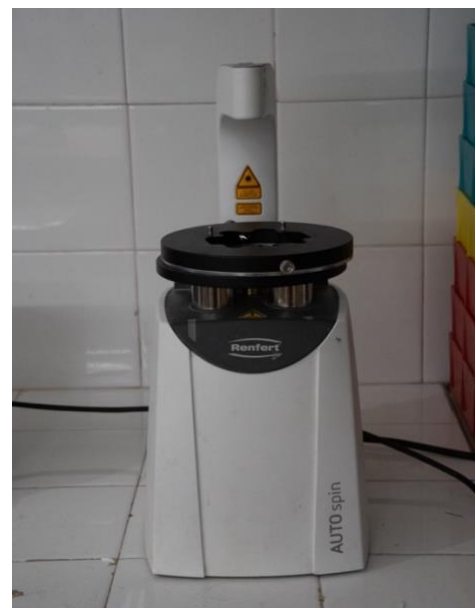
Εικόνα 47: Συσσκευή κατασκευής εκμαγείου
