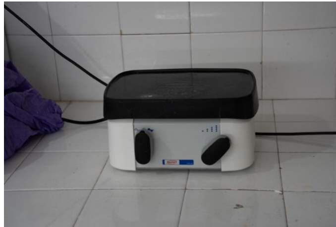
Εικόνα 45: Δονητής για αποφυγή φουσαλίδων
