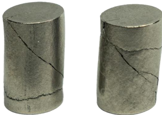
Εικόνα 23: φωτογραφία δοκιμών μετά τη φόρτιση).
