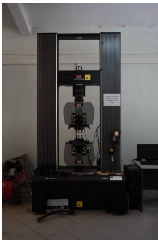
Εικόνα 60: Μηχάνημα δοκιμών θλίψης / κάμψης INSTRON – 8959
