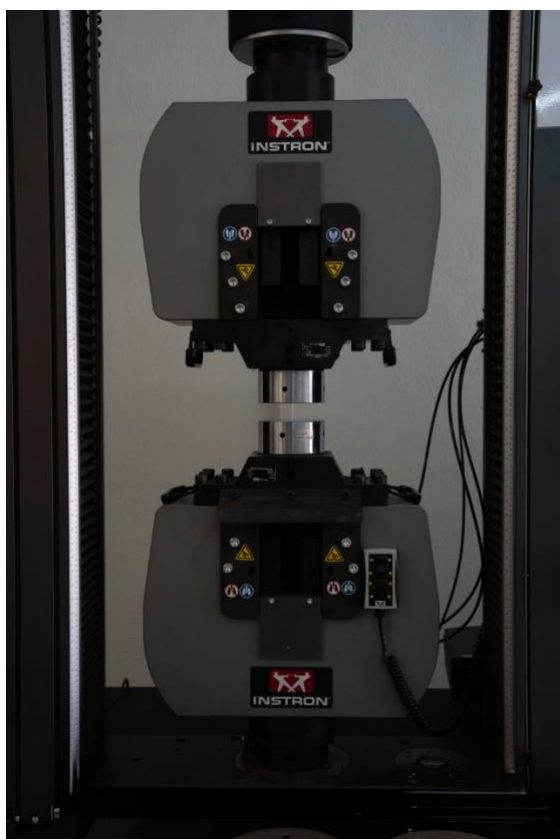
Εικόνα 59: Μηχάνημα δοκιμών θλίψης / κάμψης INSTRON – 8959
