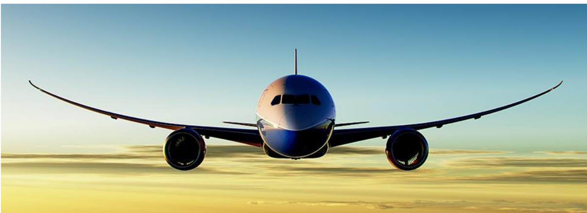
Εικόνα 22: Χαρακτηριστικά έντονο φαινόμενο παραμόρφωσης στο Boeing 787.
