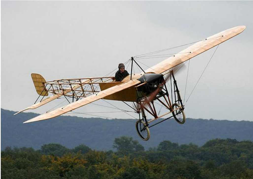
Εικόνα 18: Αεροσκάφος με δομή μορφής space frame.
