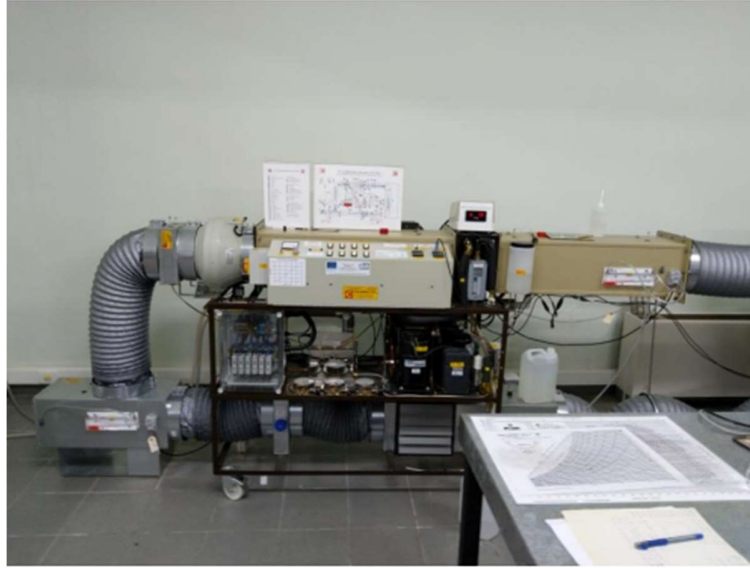
Εικόνα 31: Εργαστηριακή διάταξη Air Conditioning Laboratory Unit A660 (Πηγή: Κυριαζής, 2022)
