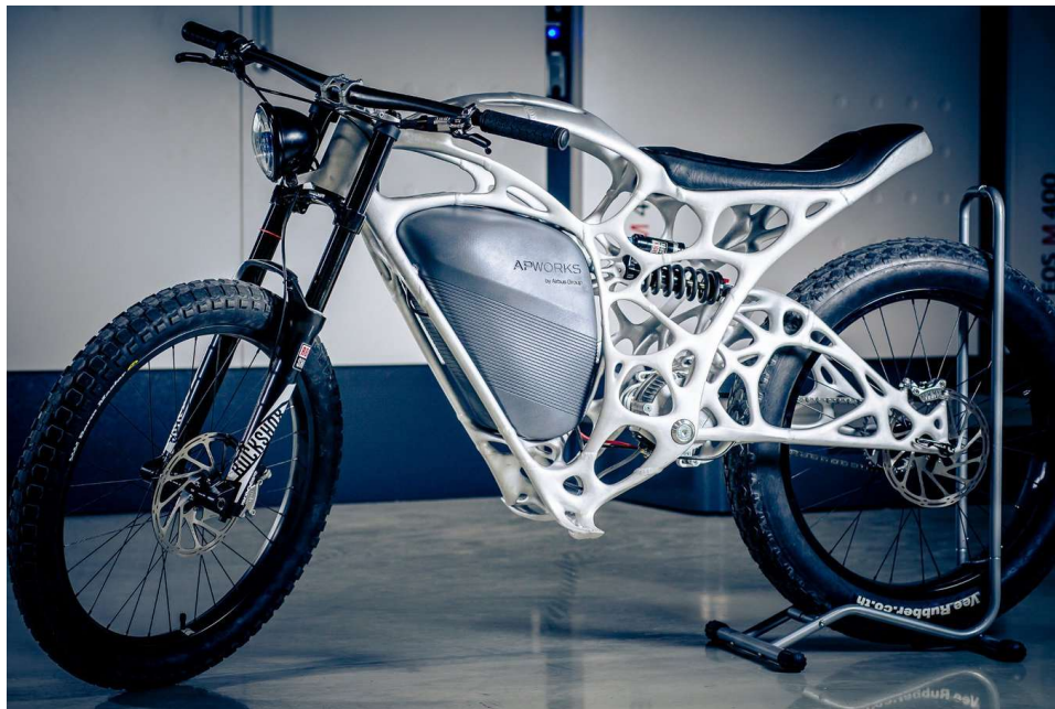
Εικόνα 4.2 Τοπολογική βελτιστοποίηση σε σασί μοτοσυκλέτας
