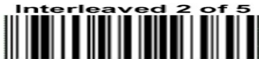
Εικόνα 1.4: Ο γραμμωτός κώδικας INTERLEAVED 2 of 5.
