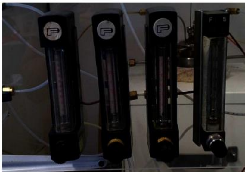
Σχήμα 4.2: Ροόμετρα μάζας (TylanFM 360).
