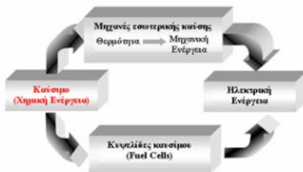
Σχήμα 1.4: Σύγκριση της κλασικής στοιχειοθεσίας μετατροπής της χημικής ενέργειας σε ηλεκτρική, με την κυψέλη καυσίμου.
