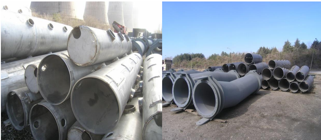
Σχήμα 3.22: Οι μεταλλικές λόγγες πριν την τοποθέτησή τους στον λέβητα [6]
