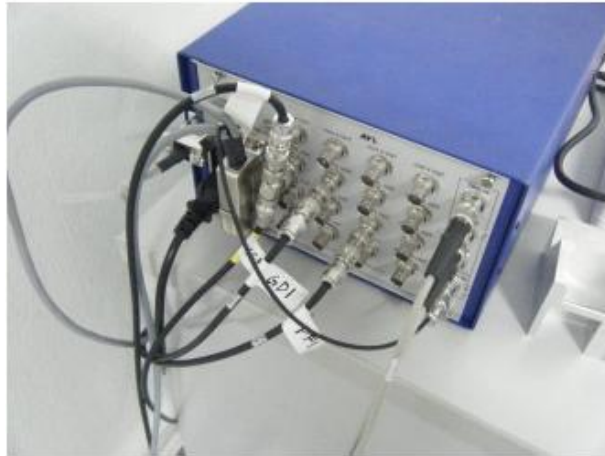
Σχήμα 6: Απεικόνιση της μονάδας χρονισμού της μηχανής [28]
