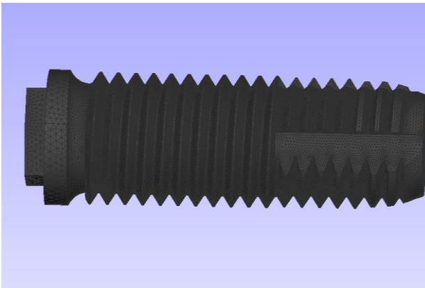
Εικόνα 4.13: Μοντέλο Εμφυτεύματος εξωτερικού εξαγώνου.
