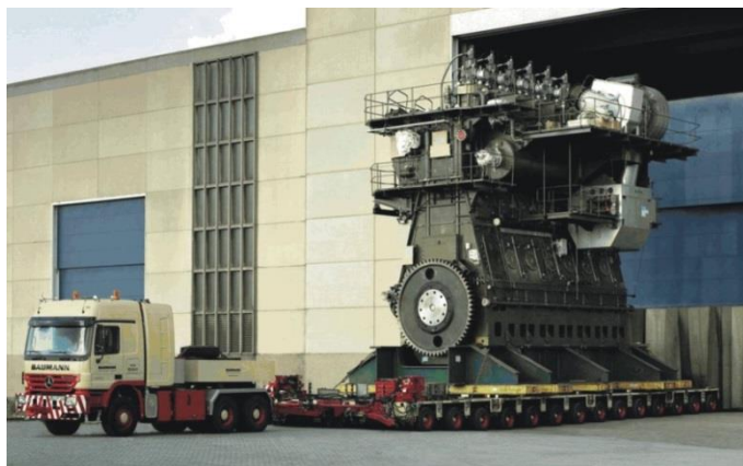
Εικόνα 6: Δίχρονος αργόστροφος κινητήρας Diesel.
