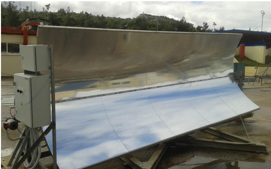
Εικόνα 5.1 :Παραβολικός Συλλέκτης, [πηγή: προσωπικό αρχείο ]
